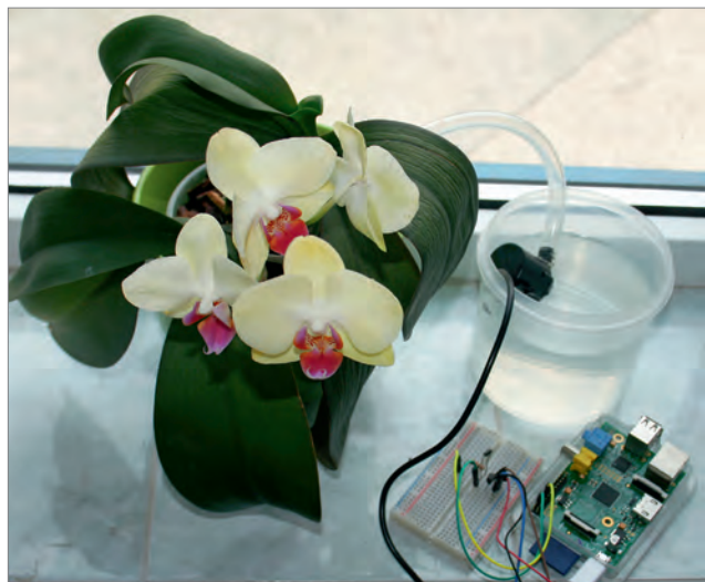
„Lazy Planting“: Bewässerungssteuerung mit dem Raspberry Pi Mit einer kleinen Schaltung, bestehend aus Transistor, Widerstand und Diode wird eine Tauchpumpe angesteuert. (Foto: Johann Stockinger)
