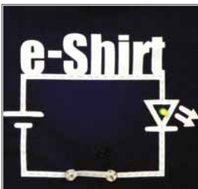
Motiv mit geschlossenem Stromkreislauf
