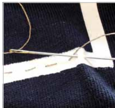
Nähen des Stromkreises mit leitendem Faden
