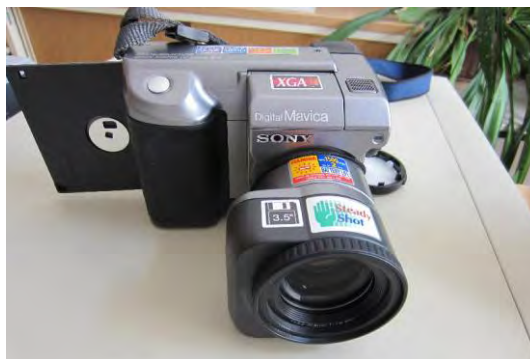
Abb. 19: Die abgebildete Mavica FD91 ist bald 15 Jahre alt und noch immer funktionsfähig, Disketten aus den 1990er-Jahren lassen sich problemlos verwenden, weil deren die Magnetbeschichtung intakt geblieben ist.
